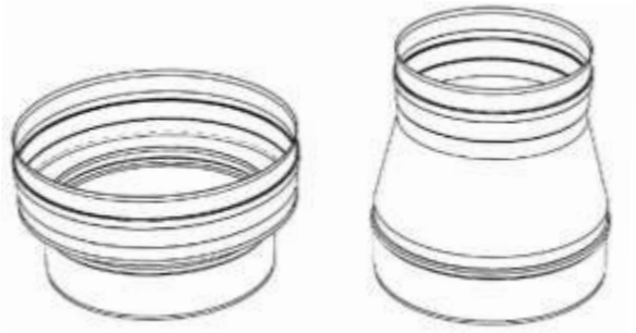
Figura 4.10, Ampliación (A) y reducción (R) concéntricas
