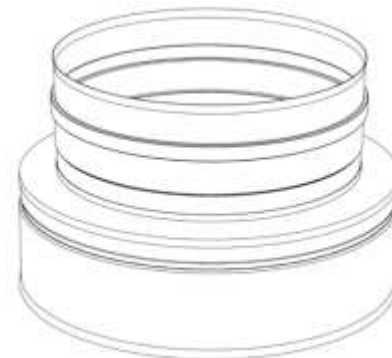
Figura 4.9, Adaptador doble a simple (37A)
