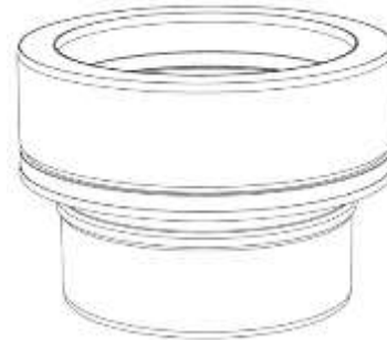
Figura 4.8, Adaptador simple a doble (37)
